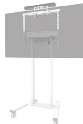
AV2-500WH Bildschirmgröße: 43-110" Tragfähigkeit: 10 kg VESA: 200x200 - 800x600
